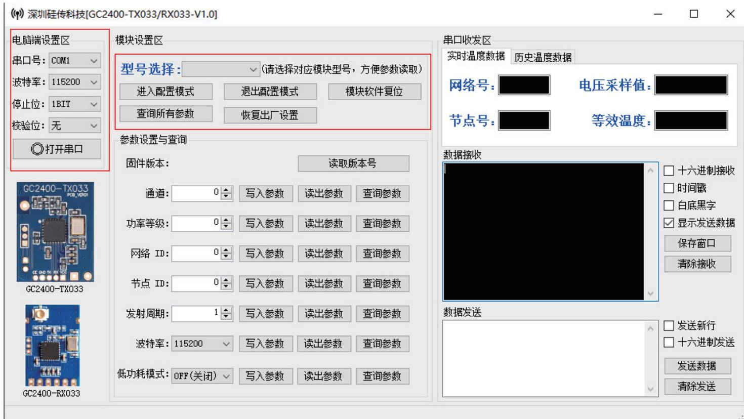
①模块出厂串口波特率为:115200、停止位1位、数据为8位、无奇偶校验，所以电脑端串口设置必须跟模块端串口设置一致才可以进行配置。
